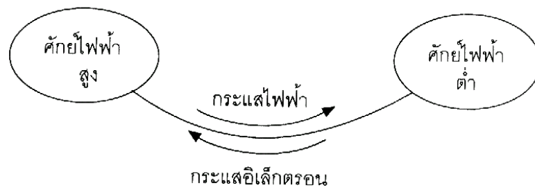
รูปที่ 3 แสดงการเคลื่อนที่ของกระแสไฟฟ้าและกระแสอิเล็กตรอน
